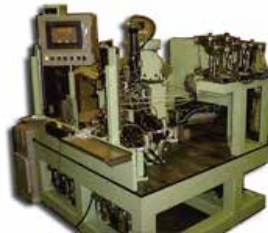
多軸ボールプラグ自動供給圧入カシメ機
