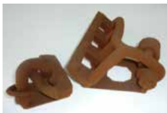
3Dレーザー焼結積層砂型
