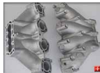
4-1型冷却管 (可傾式重力金型鋳造工法)
