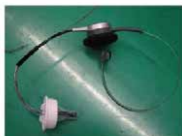
ALS患者とコミュニケーションする 端末の試作品 (噴み合わせから信号抽出)
