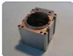
S50C HRC42 長さ40mm 上部の凹部で型彫り放電
