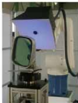
外観検査ロボット(鏡面・曲面のキズ、打痕、その他の検査)
