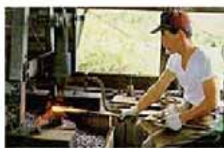
手打ち刃物製作工程
