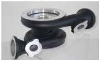
コンプレッサーハウジング (RPインクジェット積層工法)
