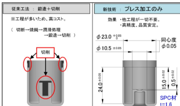
CAEを使った工程検討により、従来工法より**40%**コスト削減
