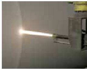
溶射皮膜は各種機能を付与 (金属/セラミック/サーメット)
