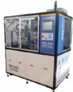
電子部品漏れ検査機
