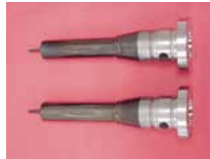
DCL金型 コーティングエリア φ300×200mmL
