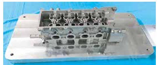
4気筒シリンダーヘッド 金属3Dプリンタ XLine製
