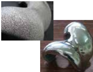
金属積層造形研磨例
