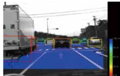
AI技術の自動車分野への応用例：前方障害物検知システム
