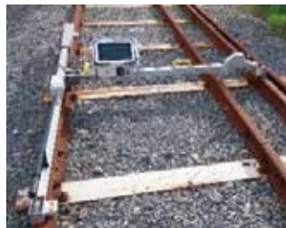
軌道検測装置メモレール ・2.5m径 ・1人で持ち運び、簡単操作 ・PC搭載でその場で確認 ・現場作業の効率化!
