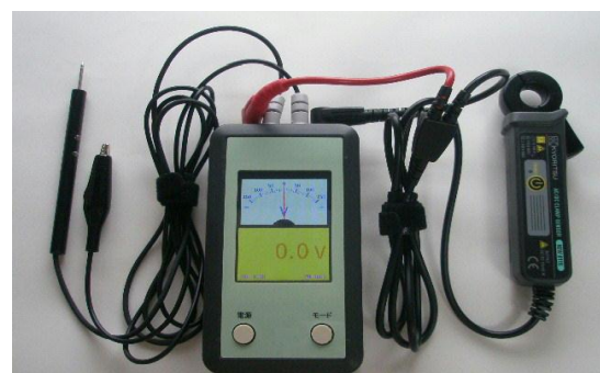
米国・中国に特許出願した 制御系作業用検電・測定器 CVE-31A
