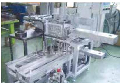
【焼成材料の型抜き装置】
