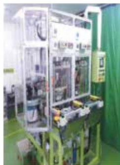
【ダイキャストへの圧入・ リークテスト装置】 精密ダイキャストワークに封 止部品などを圧入し、エア リークテストを行う装置
