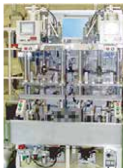
【クラッチ部品の性能検査機】 クラッチ関係部品の特性検査 などを総合的に行う装置
