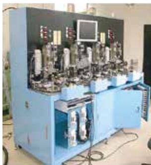
【流量検査調整装置】 小型キャブレターの 実流量を計測しデータ を基に流量を調整 する装置
