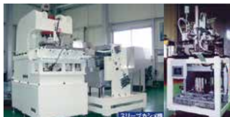
【自社開発装置 左：スリープカシメ機、右：検査装置】
