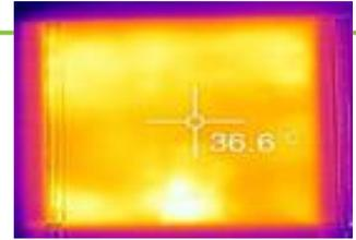
●電熱線ヒーターとファブリックヒーターの発熱状態
