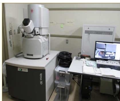
集束イオンビーム・顕微鏡装置 ミクロンレベルの微細加工、ナノオーダーの観察、分析
