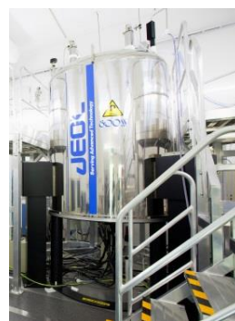
核磁気共鳴装置 極微量個体・液体で超高感度測定
