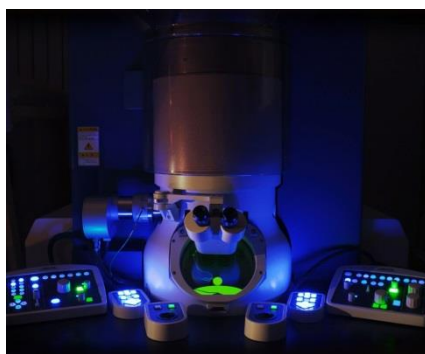
原子分解能透過電子顕微鏡 原子分解能観察・ナノ領域元素分析
