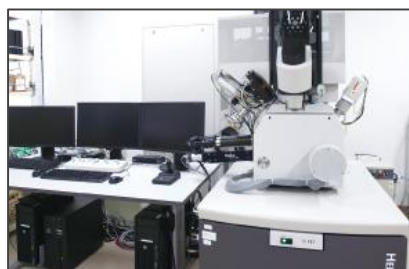
イオンビームを用いた微細加工・観察装置 (Helios NanoLab™ 600i) (FEI社製)
