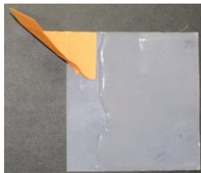
図2 フッ素樹脂にシリコンゴム/紙を接着
