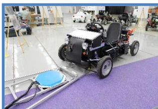
ワイヤレス給電設備
