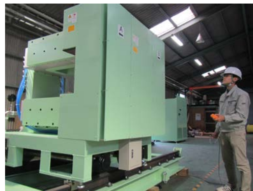
〔特殊金属向け磁場中熱処理炉〕
