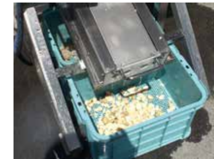
分離機にかけると、手前に脱皮された大豆、奥に薄皮が分離されてそれぞれの箱に格納される
